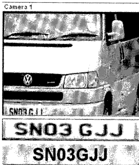
Figura 15: Ejemplo de captura y procesamiento de placas.
