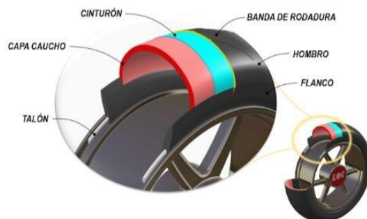
Ilustración 9. Partes de una llanta neumática de motocicleta (Teroson, s.f.).
