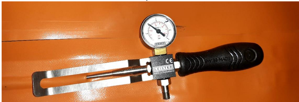
Ilustración 6-52. Control de soldadura
