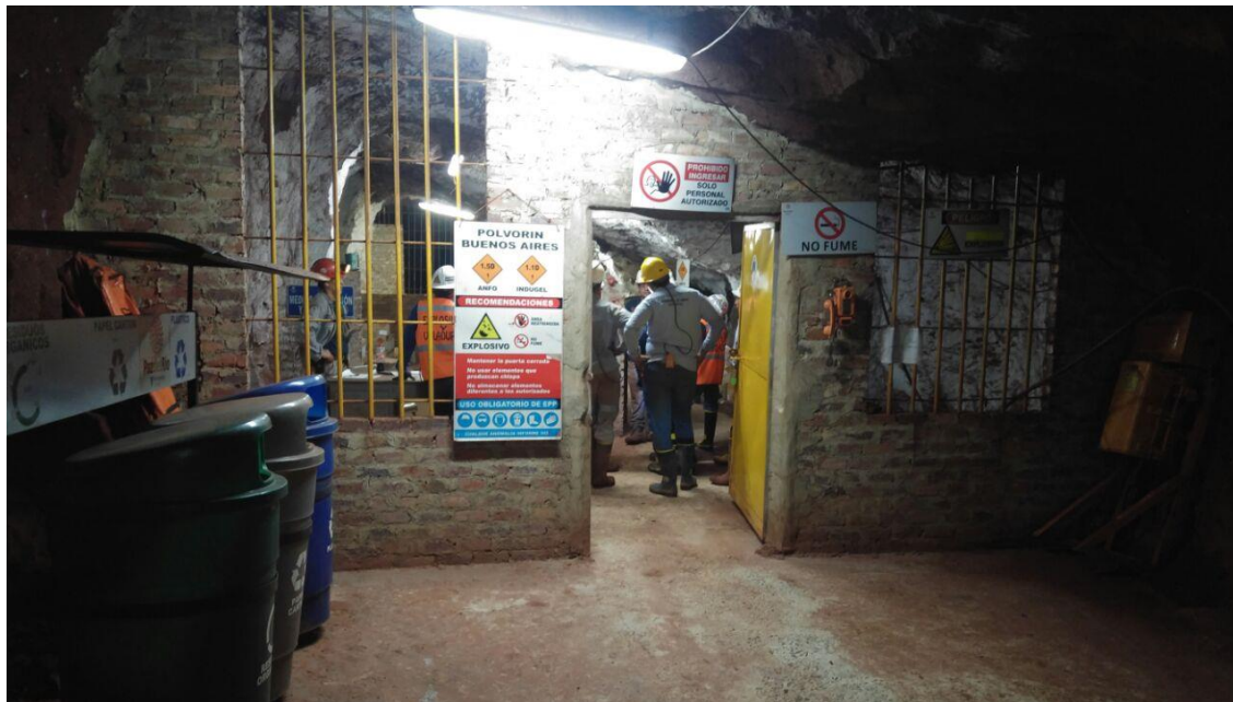
Foto 8-3. Depósito temporal de explosivos bajo tierra, demarcación
