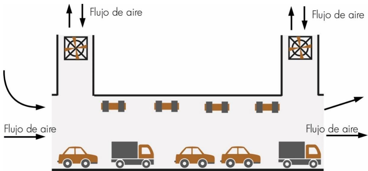
Ilustración 7-6. Ventilación longitudinal con jet fans o ventiladores a chorro
