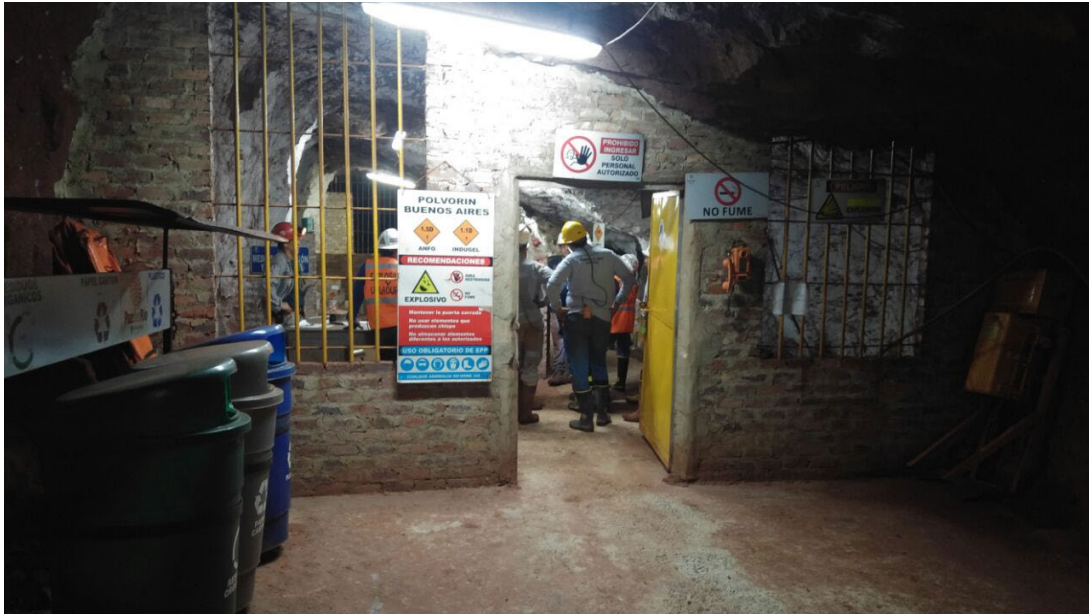
Foto 8-3. Depósito temporal de explosivos bajo tierra, demarcación
