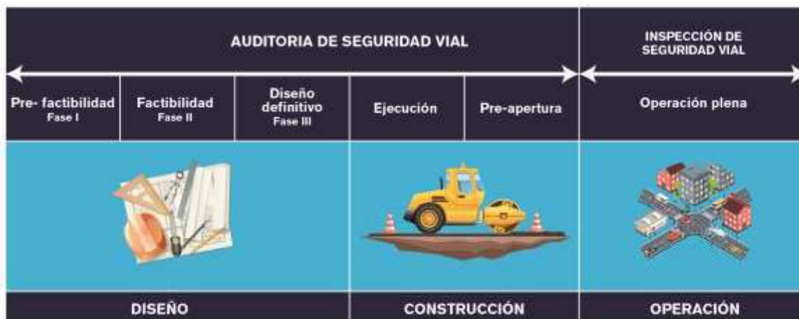
Figura 6. Auditorías e inspecciones de seguridad vial agrupadas por etapas del proyecto
