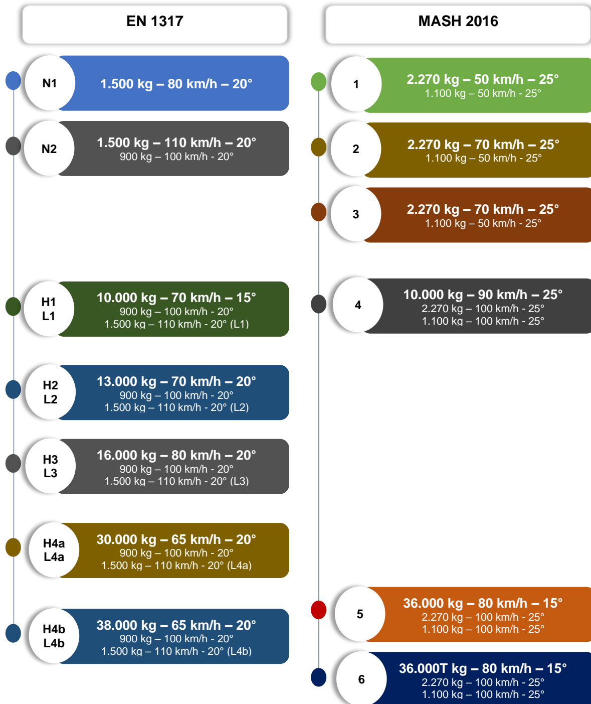
Ilustración 35. Niveles de contención para barreras de seguridad según EN 1317 y MASH 2016
