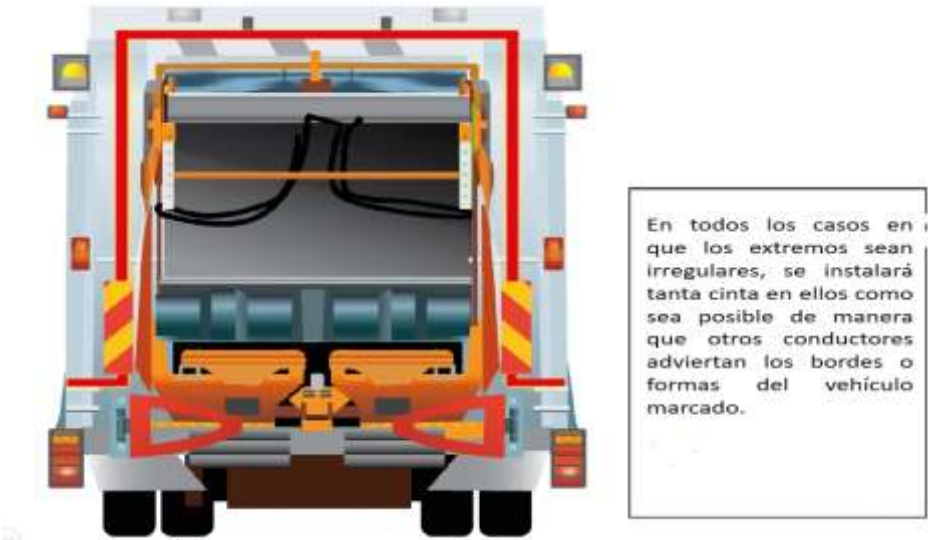
11. INSTALACIÓN TRASERA EN CARROTANQUE
