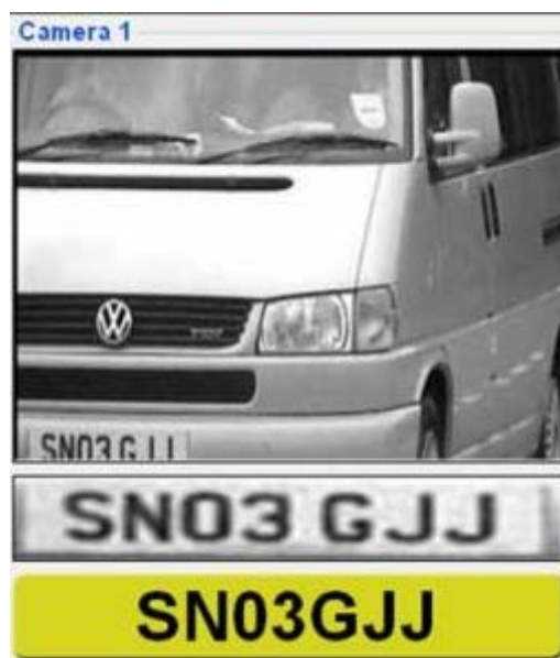
Figura 4: Ejemplo de captura y procesamiento de placas.
