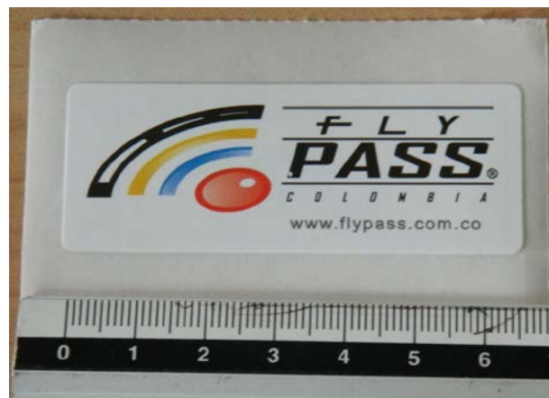
Figura 1: Tag-calcomanía RFID
