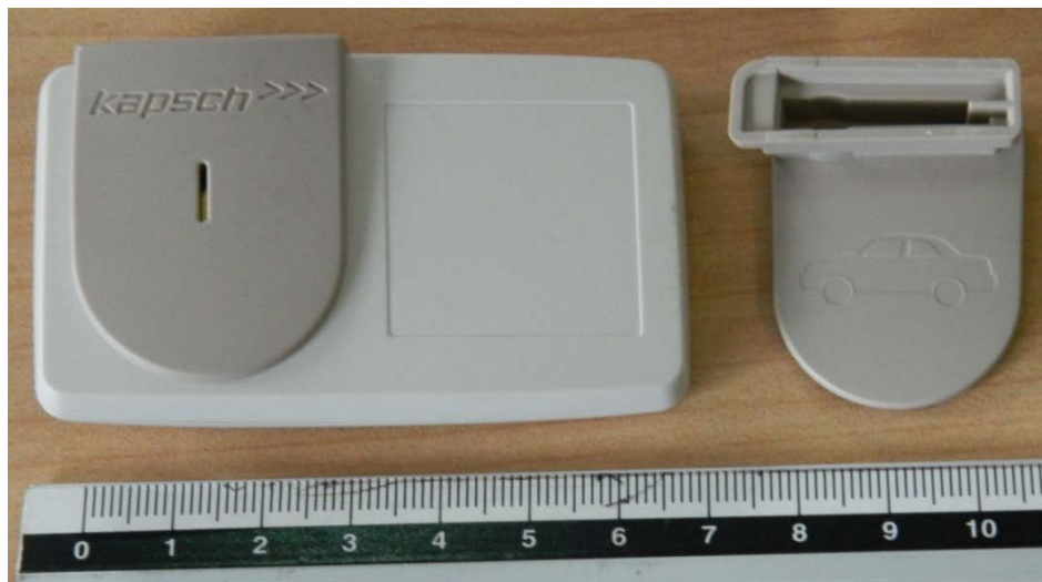
Figura 2: Dispositivo a Bordo CEN DSRC con sujetador
