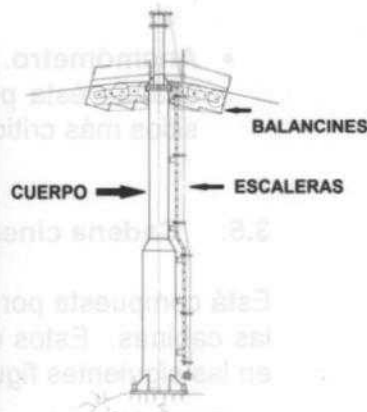
Figura 29. Foto de un apoyo de tipo tubular del teleférico del Parque Chicamocha – Santander y esquema de un apoyo tipo tubular.
