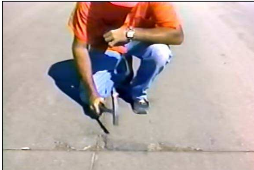
Figura 7-28 Golpeo con martillo para detectar el sonido del concreto deteriorado
