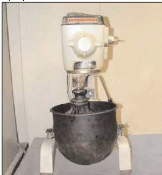
Figura A5-5 Mezcladora típica para la elaboración de mezclas de concreto asfáltico en el laboratorio
