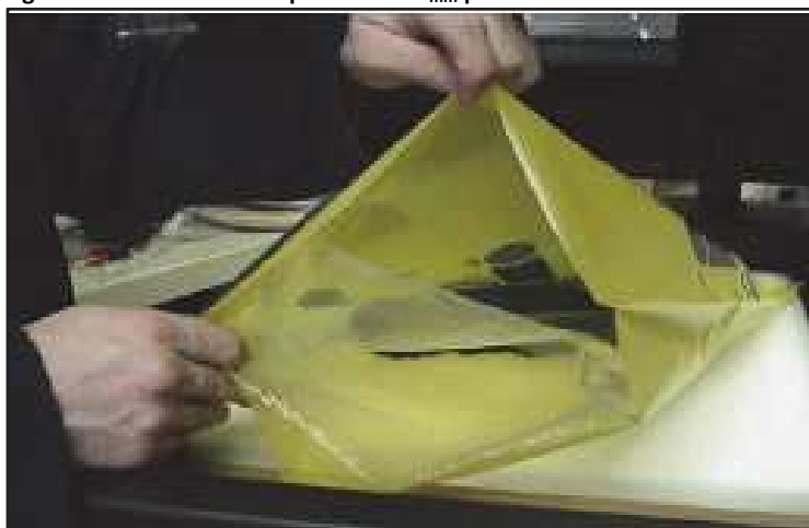
Figura A5-9 Mezcla suelta para hallar G_{mm} por el método de sellado al vacío
