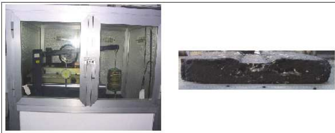
Figura A5-21 Cámara para el ensayo de pista de laboratorio y probeta ensayada
