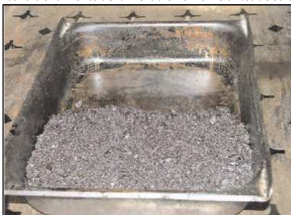
Figura A5-6 Acondicionamiento de la mezcla en el horno antes de su compactación
