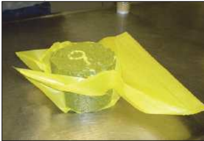
Figura A5-7 Probeta Marshall sellada al vacío
