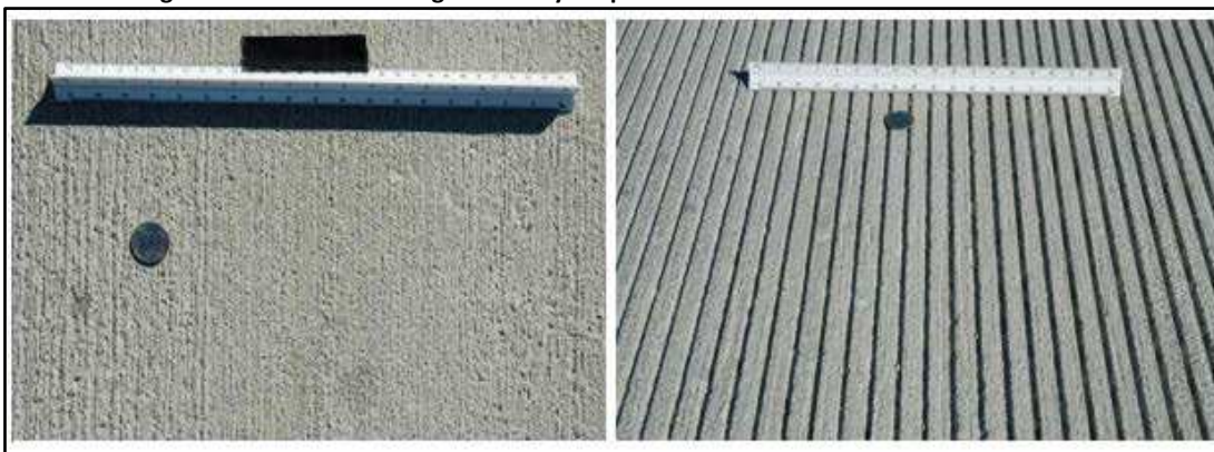
Figura A2A-1 Pavimento rígido antes y después de ser texturizado mediante ranurado
