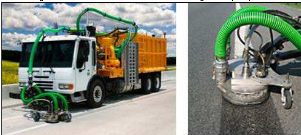
Figura 5-12 Eliminación de marcas viales con chorro de agua de muy alta presión
