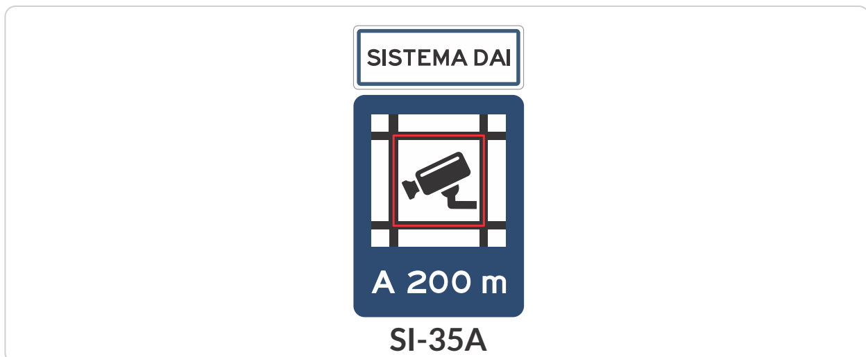
Figura 9-28. Señalización para cámara de detección Automática de Incidentes - DAI
