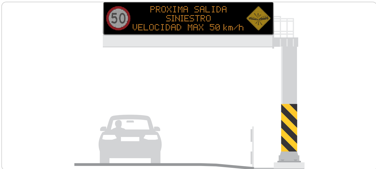
Figura 2-84. SMV con dos pictogramas laterales y una zona alfanumérica, sobre soporte tipo banderola
