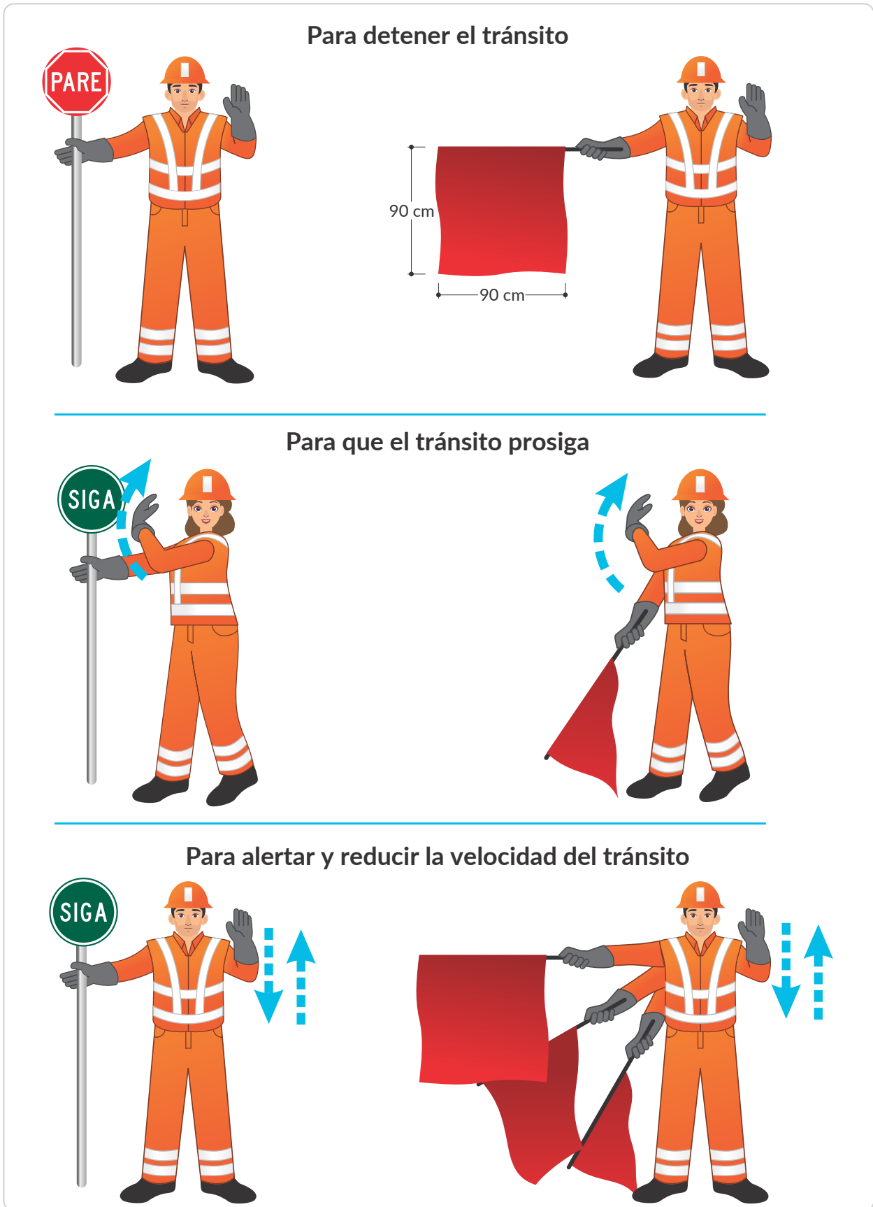
Figura 7-24. Operaciones con indicaciones PARE y SIGA
