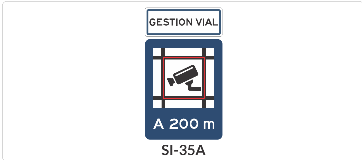
Figura 9-31. Ejemplo de señalización para sistema SAT
