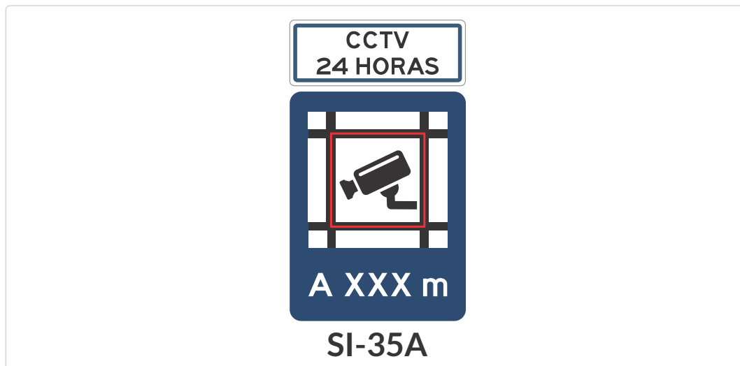
Figura 9-27. Señalización para cámaras en estaciones de peaje
